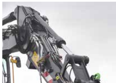
Lasthållningsventiler på skopocylindrarna, båda sidor
